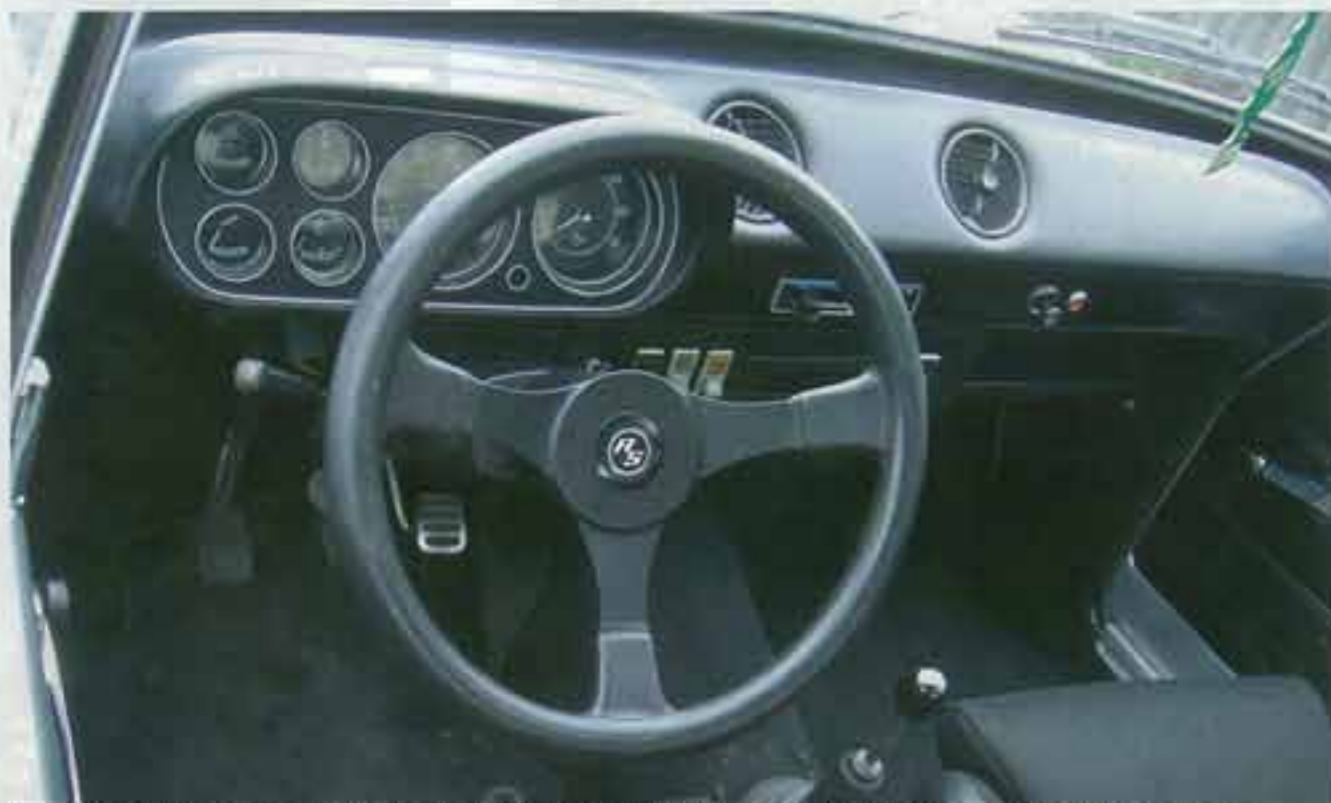
De instrumenten waren, afhankelijk van de lengte van de chauffeur, min of meer goed af te lezen. Op de toerenteller ontbreekt de rode zone.
