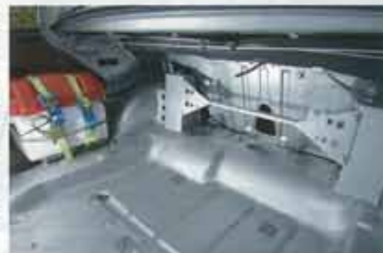
In de koffer zie je duidelijk de versterking van de achterophanging en de montagepunten van de rechtop geplaatste schokdempers. De batterij verhuisde van het motorcompartiment naar de koffer.
